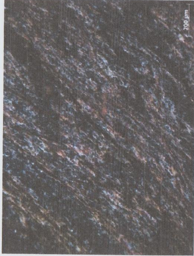
ຮູບທີ 13: ຫີນ Siltstone - Sericite - Chlorite ຕົວຢ່າງ A. 056 Nikon N+
